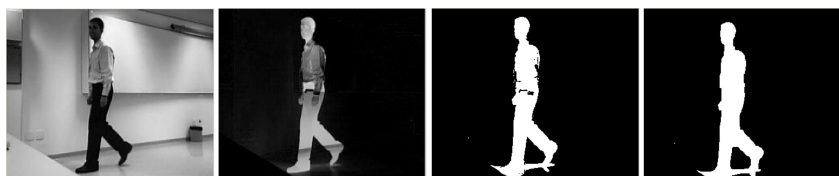
Figura 1 - Imagem original (a), subtração de fundo (b), limiarização (c) e abertura morfológica (d). Fonte: Projeto Câmera Kombat ( http://camerakombat.googlepages.com )
